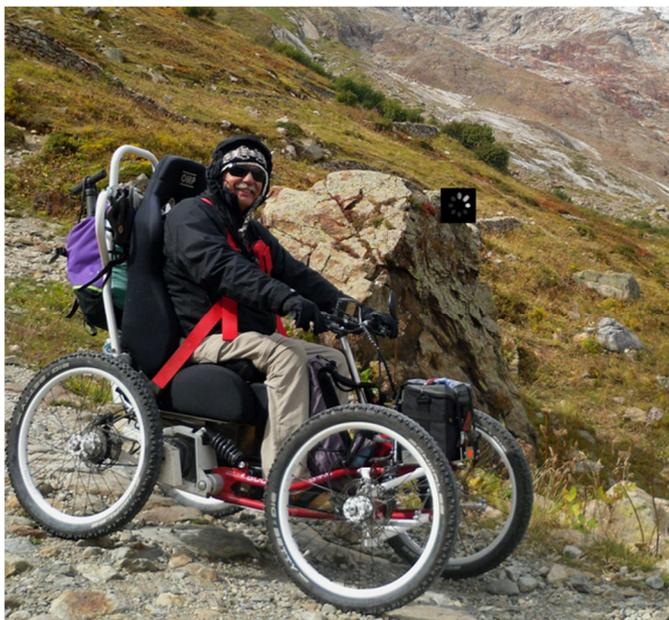
Il est propulsé par deux moteurs électriques développant au maximum 2500 Watts.
